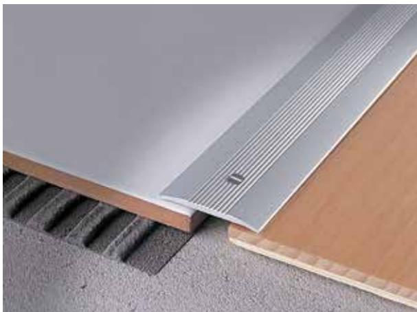
Los perfiles STRIPTEC se utilizan para unir pavimentos de igual o diferente material y espesores. La forma redondeada del perfil permite una ligera rotación compensando diferencias de nivel de hasta 5 mm. La aplicación de STRIPTEC corrige las eventuales astillas de los pavimentos o la no perfecta aproximación en fase de corte cubriendo la unión. También se pueden utilizar como terminales de recubrimientos con un espesor no superior a 5 mm.
